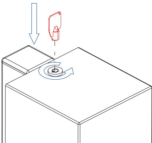
**CS** Kontrola stavu napájecí baterie**SK** Kontrola stavu napájacej batérie**EN** Battery capacity control**RU** Проверка состояния питания батареи**DE** Batteriezustandsanzeige**PL** Kontrola stanu baterii zasilającej**RO** Controlul capacitatii bateriei**ES** Control de la capacidad de la batería**FR** Contrôle de capacité de la Batterie**NL** Indicatie Batterij status**LT** Maitinimo baterijos patikrinimas
